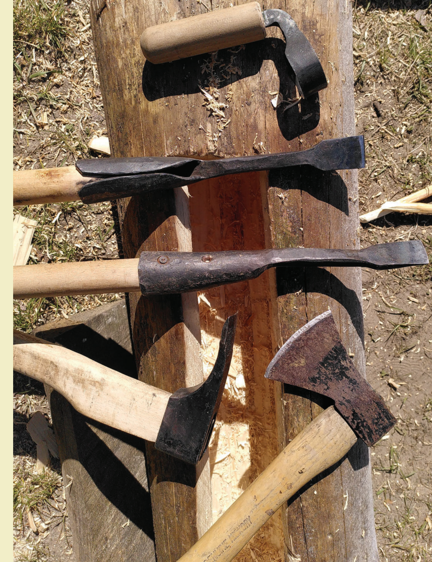
Die traditionellen Werkzeuge sind gut geeignet, um die gut 50 l großen Hohlräume in die Baumstämme einzuarbeiten. Fotos: Ch. Bergmann, I. Engel
