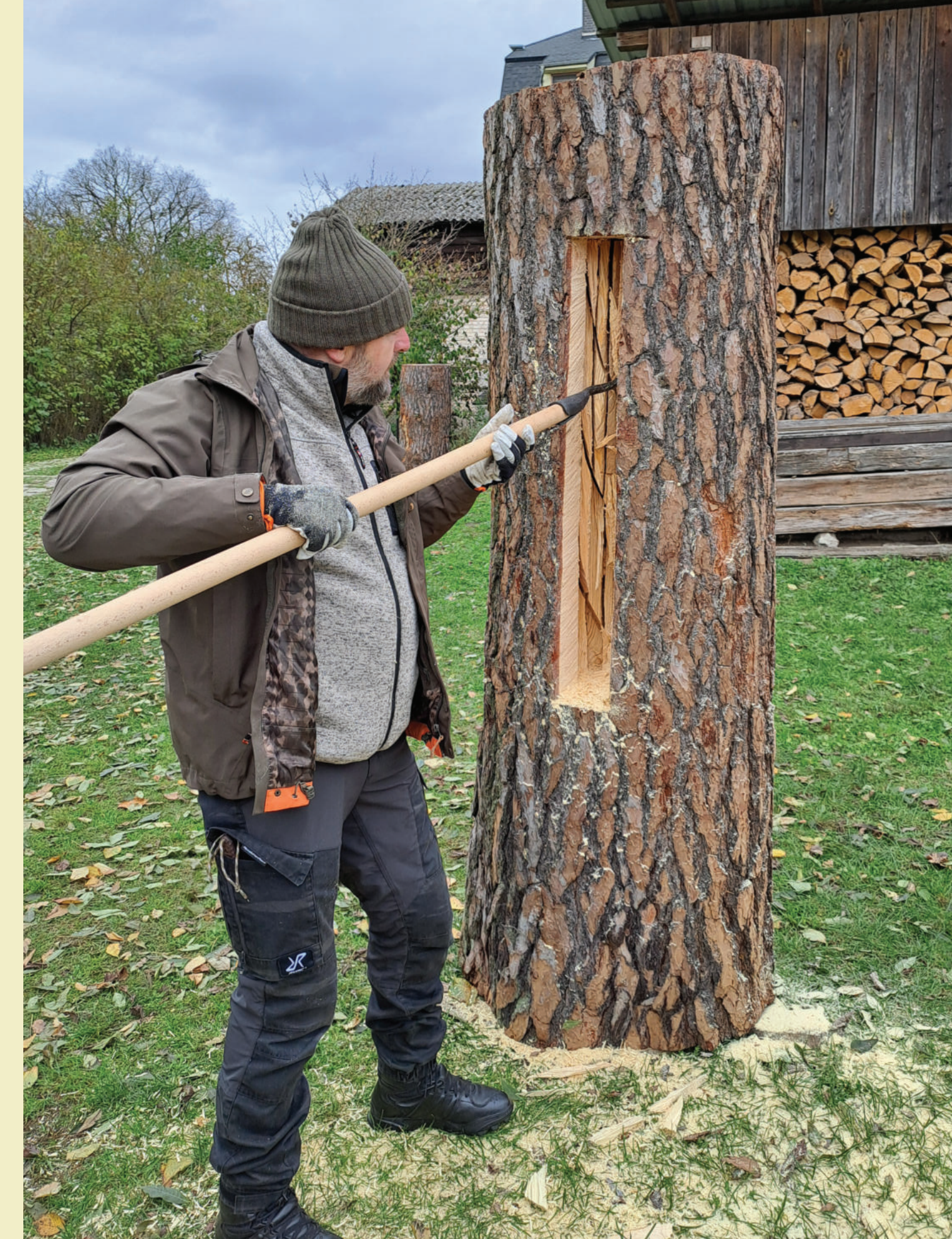
Die traditionellen Werkzeuge sind gut geeignet, um die gut 50 l großen Hohlräume in die Baumstämme einzuarbeiten. Fotos: Ch. Bergmann, I. Engel
